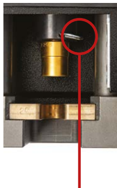
Federspanne zum sichern des Montagestutzen
