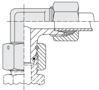
Lubrifiez le filetage du raccord à visser et le joint torique du côté du raccord 24° (DKO). Insérez les raccords avec cônes 24° dans un raccord à bague 24° et serrez manuellement. Pour l'assemblage final côté raccord 24°, serrez l'écrou de raccord de 1/4 à 1/2 tour. Le raccord à visser doit être maintenu à l'aide d'une clé appropriée.
