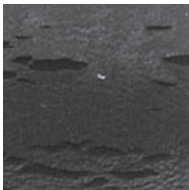
클로로프렌고무 24시간에 균열 발생
