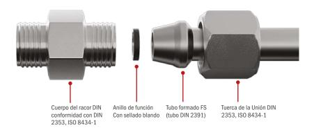
Como conexión sin corte, el sistema Gates FS también se puede usar en áreas relevantes para la seguridad donde no se pueden usar conexiones de corte.
