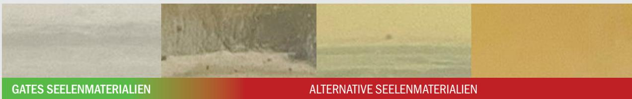
PG25-KÜHLMITTEL TESTS MIT VERSCHIEDENEN RECHENZENTRUMSSCHLÄUCHEN BEI 80°C UND 600 STUNDEN
