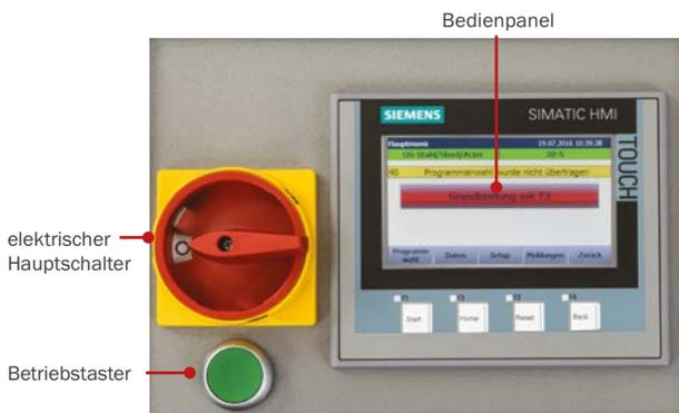
Die Kolbenstange wird durch Drücken des grünen Betriebstasters neben dem Bedienpanel in Bewegung versetzt.
