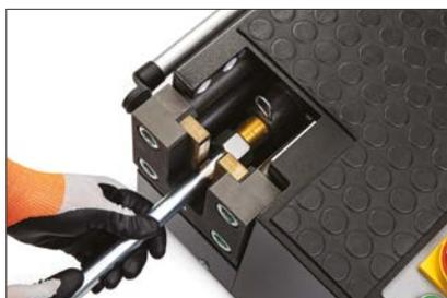
Die Steuerung registriert in beiden Fällen des Stillsetzens einen Montageabbruch, nach Drücken der Taste F3 auf dem Bedienpanel fährt das Presswerkzeug zurück in die Grundstellung und gibt die Werkstückeinlage wieder frei.
