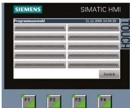
Hier erscheinen die vom Einrichter freigegebenen Programme. Durch Berühren der Programmtaste wird das Programm angewählt. Die Anlage springt zurück in das Hauptmenü.
