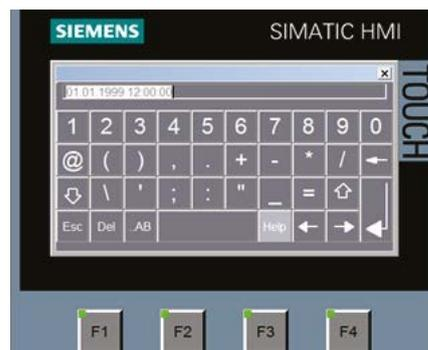
Hier, wie nach Anwahl jedes der zwei folgenden Fenster erscheint die Tastatur, über die Datum und Uhrzeit eingegeben werden können. Die Eingaben werden durch Berühren der Schaltfläche „ENTER“ abgeschlossen und die Uhr beginnt zu laufen.
