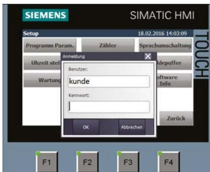
Sobald eines der beiden Eingabefenster berührt wird, erscheint die Tastatur, über die sowohl der Benutzername wie das Kennwort eingegeben werden können. Die Eingaben werden durch Berühren der Taste „ENTER“ abgeschlossen.
