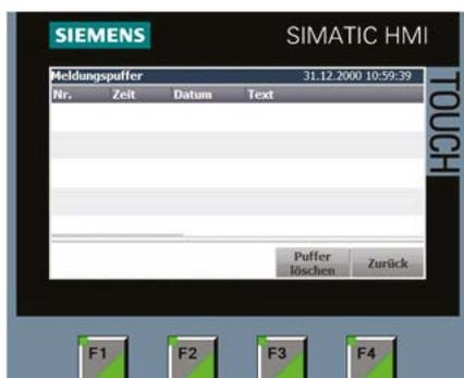
Hier werden alle Störmeldungen, die im Meldefenster angezeigt und gelöscht wurden, aufgeführt. Auch dieser Meldepuffer kann bei Bedarf durch den Zugangsberechtigten gelöscht werden.
