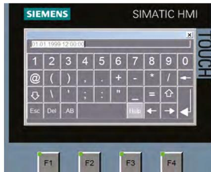
Aquí, como después de la selección de cada una de las dos ventanas siguientes, aparece el teclado para que pueda introducir la fecha y la hora. Las entradas se finalizan pulsando la tecla "ok" y el reloj empieza a funcionar.
