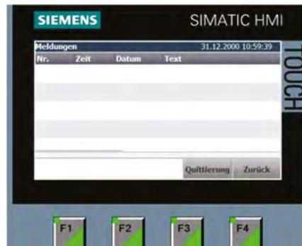
Después de seleccionar el botón de mensajes, aparece esta pantalla y se muestran todos los mensajes de error pendientes según la lista, y los mensajes pueden confirmarse pulsando el botón "Confirmar" y borrarse.
